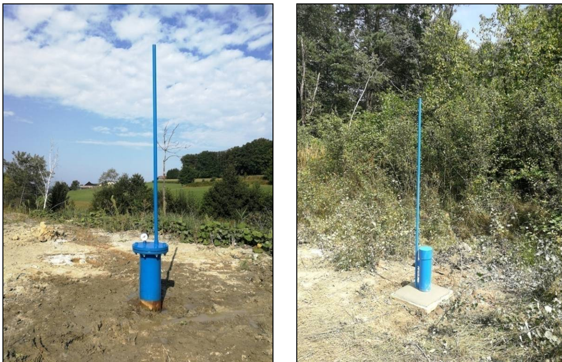
Slika 13: Urejeni ustji piezometrov PZ-1/18 in PZ-2/18
